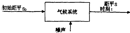
图3 以初始距平为输入和时刻 t 的距平为输出的气候系统。图上所示加给系统的噪声实际上是由系统的内部机制产生的
