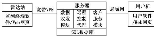
图1 天气雷达实时监测系统结构 (VPN:虚拟专用网;SQL:结构化查询语言)
